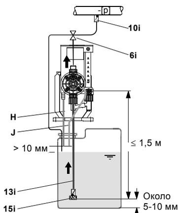
Рис. 13 Пример установки насоса с системой Plus<sup>3</sup>
