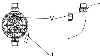
Рис. 32 Ручная деаэрация дозирующей головки (при работающем насосе)
