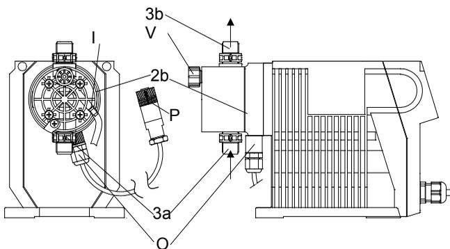
Рис. 5 DDI 209 с датчиком утечки мембраны
