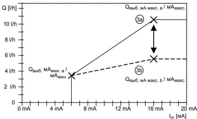
Рис. 52 Входной и выходной ток с последующим масштабированием
