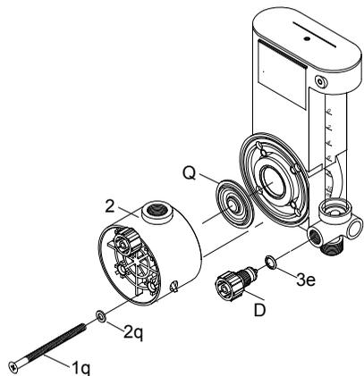
**Рис. 73** Замена мембраны с системой Plus<sup>3</sup>
