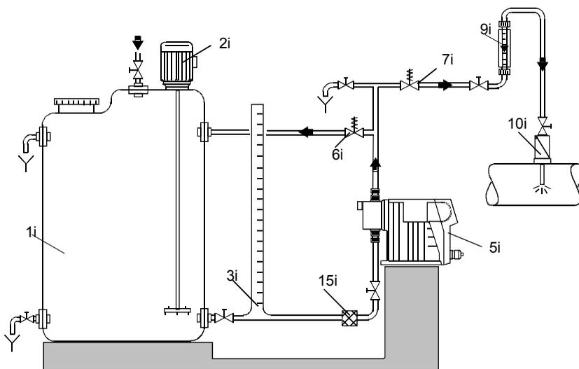
Рис. 12 Пример установки насоса с ручной деаэрацией
