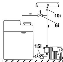
Рис. 17 Установка с предохранительным клапаном и фильтром
