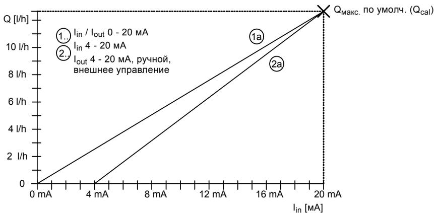
**Рис. 50** Входной и выходной ток со стандартными параметрами
