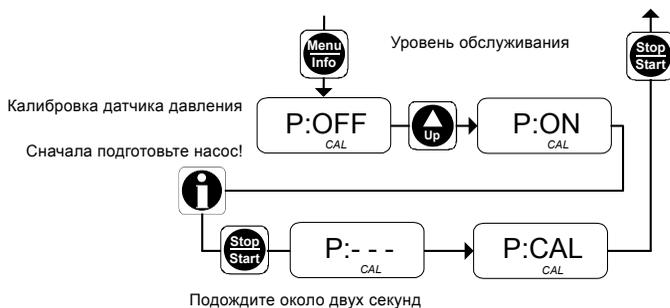
Рис. 64 Калибровка датчика давления
