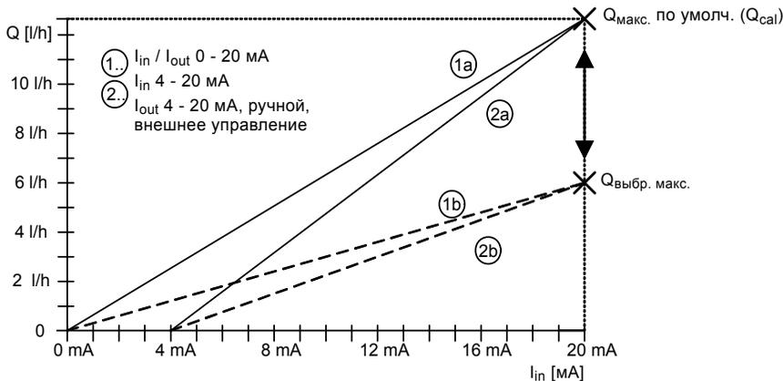
Рис. 51 Входной и выходной ток с непосредственным масштабированием
