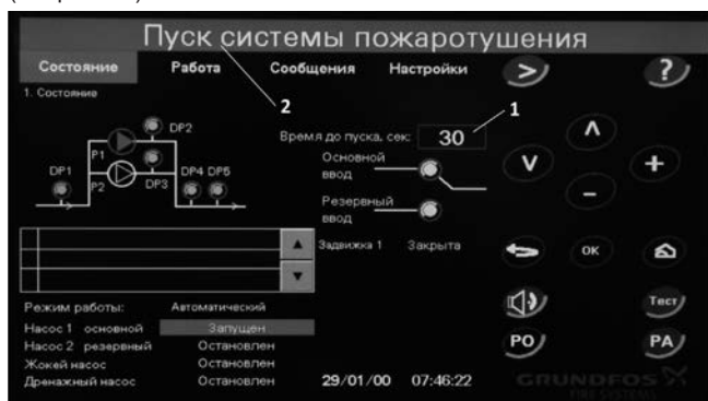
Рис. 14 Меню «Состояние» при поступлении сигнала на запуск
