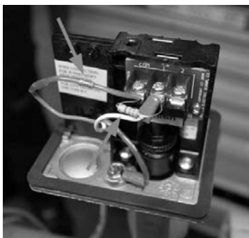
3-сүр. Басым релесинин корпусунда каршылыктарды (резисторлорду) орнотуу мисалы
