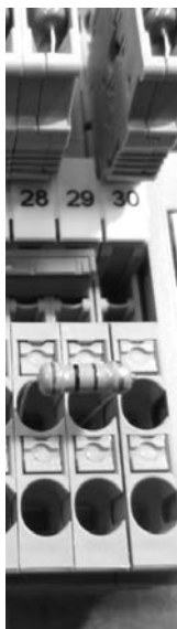
4-сур. РТС датчигінің қосылым клеммаларына кедергіні (резисторды) орнату мысалы
