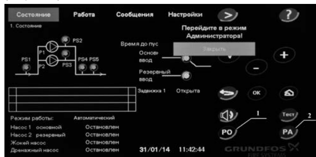
Рис. 10 Экран панели оператора после нажатии кнопки «РА»
