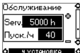
Строка 1: Задайте число часов работы электродвигателя, после которых блок МР 204 покажет на дисплее предупреждение о том, что пора произвести техническое обслуживание.
