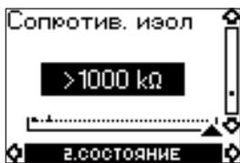
Сопротивление изоляции по отношению к земле измеряется на проводах питания и на обмотках двигателя.
