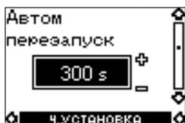
Задание времени, после которого блок МР 204 автоматически пытается запустить электродвигатель после отключения.
