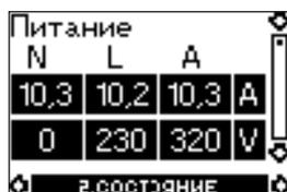
Пример измерения однофазного тока и напряжения.
