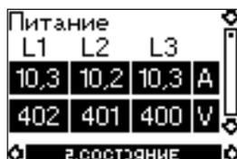
Пример измерения трехфазного тока и напряжения. Блок МР 204 измеряет все напряжения между линиями и ток во всех линиях. Напряжение отображается следующим образом:
