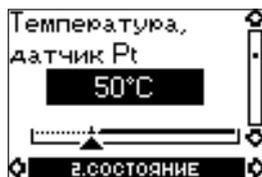
Фактическая температура, измеренная с помощью датчика Pt100/Pt1000.
