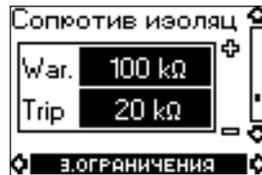
Նախագգուշացման և անջատման շեմային մեծությունները ըստ տեղադրված սարքավորման մեկուսացման դիմադրության: Սահմանված մեծությունը պետք է լինի բավականին փոքր, որպեսզի ապահովի սարքավորման մեջ անսարքությունների վաղ ինդիկացումը:
