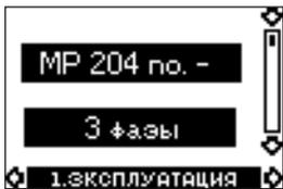
Տվյալների առաջին փոխանակումից հետո գործարկման պատուհանը ցույց է տալիս կարգավորման հիմնական պարամետրերը: Այս պատուհանը ցույց է տալիս, որ կապ էր հաստատվել MP 204 բլոկի հետ և MP 204 բլոկի համարը կայանքում: Մատակարարումից հետո MP 204 բլոկին ոչ մի համար չի նշանակվել: Դիսփիլեյը ցույց է տալիս ,-ե: Դիսփիլեյը նույնպես ցույց է տալիս, որ MP 204 բլոկը կարգավորված է առանց հողանցման եռաֆազ համակարգում աշխատանքի համար: **Նշում:** Այս պատուհանը գոյանում է MP 204 բլոկի հետ տվյալների սկզբնական փոխանակումից հետո:
