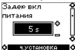
MP 204 блогында кернеудің пайда болу сәтінен бастап ажыратушы реленің (95-96 клеммалары) және сигнал беру релесінің (97-98 клеммалары) іске қосылу сәтіне дейін секундтардағы уақыты.
