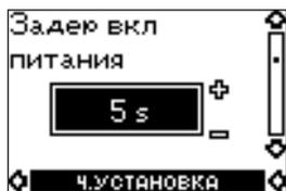
Время в секундах от момента появления напряжения на блоке МР 204 до момента включения реле отключения (клеммы 95-96) и реле сигнализации (клеммы 97-98).
