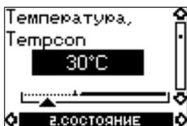
Фактическая температура электродвигателя, измеренная с помощью датчика Темпер.
