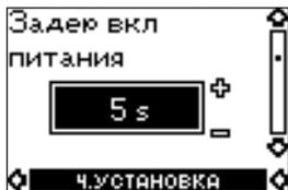
Өчүрүү релеси (клеммалар 95-96) жана сигнализациянын релеси (клеммалар 97-98) күйгөнгө чейин MP 204 блогунда чыңалуу пайда болгон учурдан баштап секунд менен убакыт.
