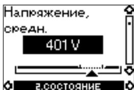
В случае однофазного подключения, это окно показывает напряжение линии питания UL-N.
