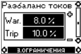
Նախագգուշացման և անջատման շեմային մեծությունները ըստ հոսանքի դիսբալանսի: Հաշվարկի նկարագրությունը տես *Հոսանքի դիսբալանս* բաժնում:
