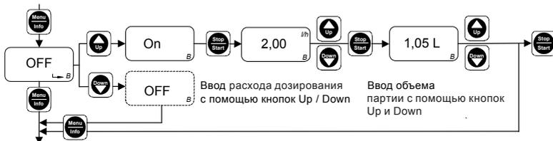
Рис. 52 Настройка дозирования в режиме «Партия»
