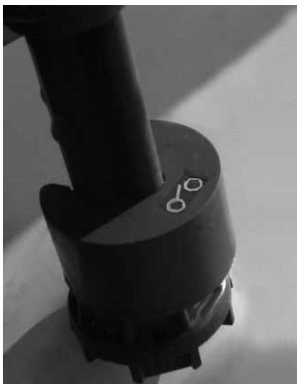
Рис. 14 Правильное направление поплавка
