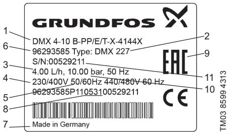
2-сур. DMX түрлі сорғылардың фирмалық тақтайшасы
