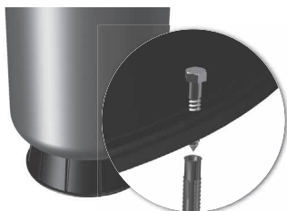
Fig. 4 Instalación del depósito con soporte de plástico
