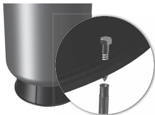
Fig. 4 Instalarea rezervorului cu bază de plastic
