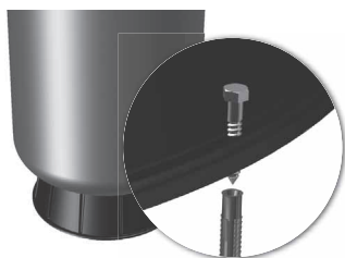
Рис. 4 Монтаж бака с основанием из пластика
