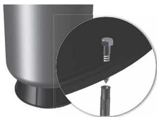
Fig. 4 Montering af beholder med fodstykke af plast
