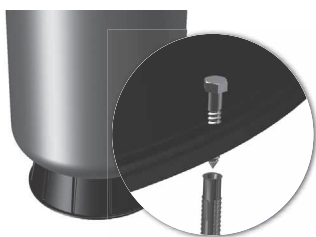
Fig. 4 Installazione di serbatoi con base in plastica
