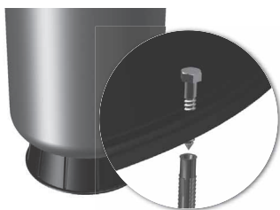
Obr. 4 Instalace nádrže s plastovou základnou
