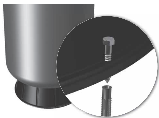
Fig. 4 Instalação de um depósito com base de plástico
