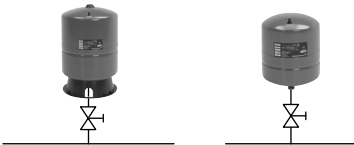
Fig. 7 Válvulas de seccionamento
