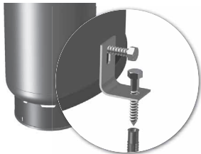
Obr. 3 Instalace nádrže s ocelovou základnou
