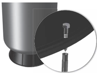
Afb. 4 Opstelling van een drukvat met kunststof voetstuk
