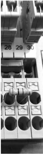
Նկար 7 Դիմադրության (ռեզիստորի) տեղադրման օրինակ
