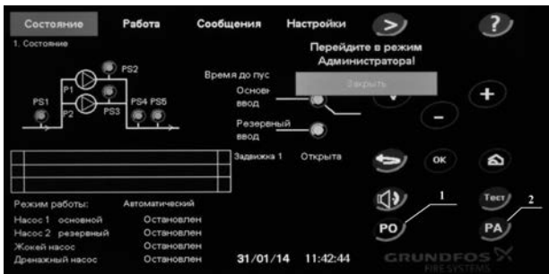
Նկար 13 Օպերատորի պանելի էկրանը՝ «ԱՌ» կոճակի սեղմելուց հետո
