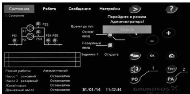
13-сүр. «АШ» баскычын баскандан кийин оператордун тактасынын экраны
