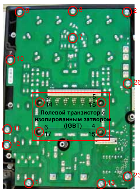
Рис. 56 Порядок затяжки винтов платы инвертора
