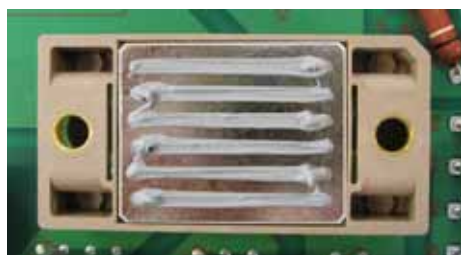
Рис. 50 Рисунок нанесения охлаждающей пасты на выпрямитель.
