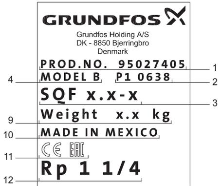
**Рис. 7** Фирменная табличка скважинных насосов SQF (Helical)
