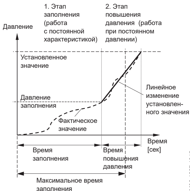
Рис. 33 Этапы заполнения и повышения давления
