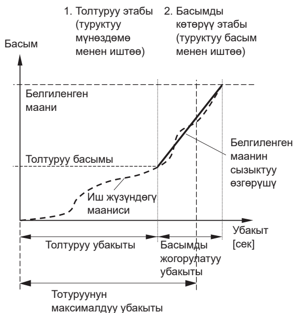
33-сүр. Толтуруу жана басымды жогорулатуу этаптары
