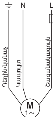
Նկար 19 Երկհաղորդալար մալուխով էլեկտրաշարժիչներ
