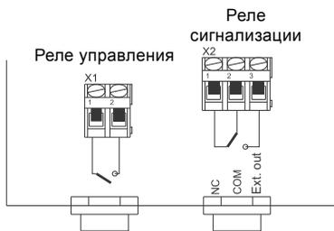
Рис. 3 Реле управления и сигнализации
