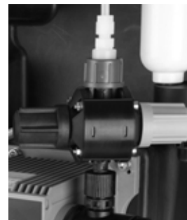
Рис. 42 Многофункциональный клапан на дозировочном насосе
