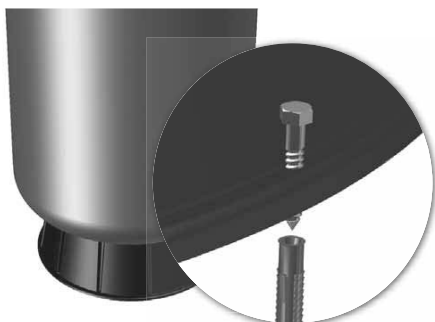
Рис. 6 Монтаж бака с основанием из пластика
