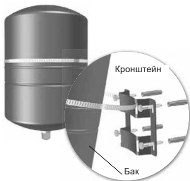
Рис. 7 Пример монтажа на стену с использованием настенного кронштейна
